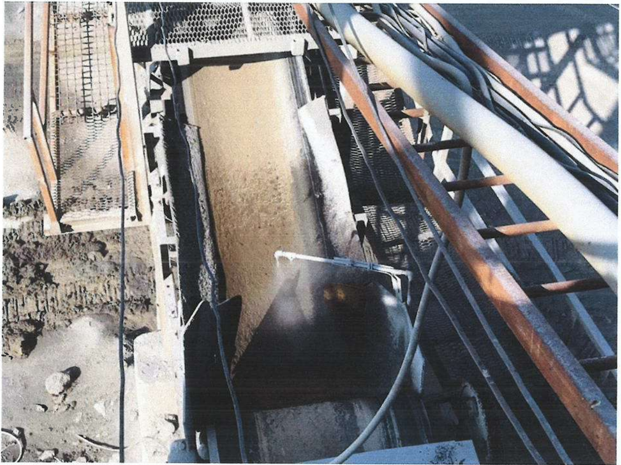
รูปที่ 5 การติดตั้งสเปรย์น้ำบริเวณโรงโม่เพื่อลดฝุ่น (ต่อ)
