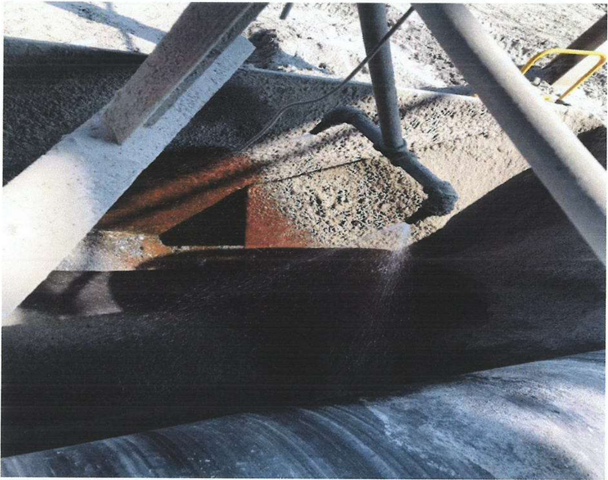
รูปที่ 5 การติดตั้งสเปรซน้ำบริเวณโรงโม่เพื่อลดฝุ่น (ต่อ)
