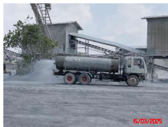
รูปที่ 16 การฉีดพรมน้ำบนเส้นทางขนส่งแร่
